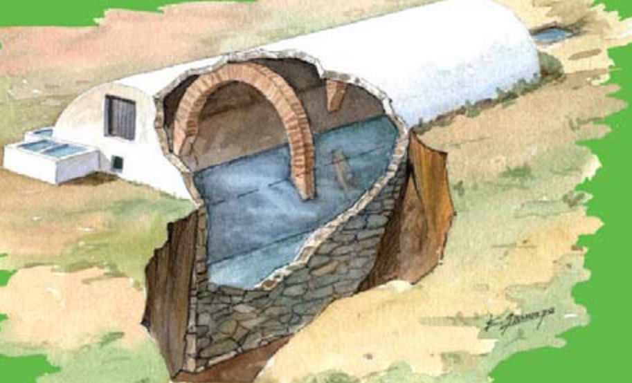
Esquema con los detalles constructivos de un aljibe
