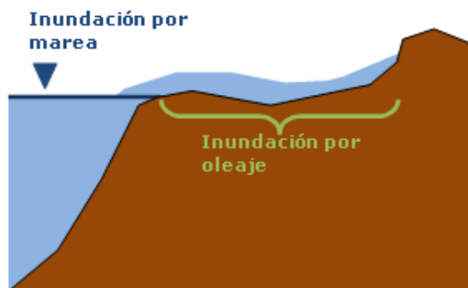
Figura nº 36. Esquema de inundación por marea e inundación por oleaje
