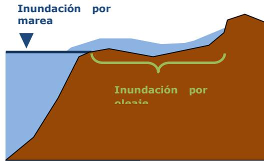
Figura nº34. Esquema de inundación por marea e inundación por oleaje.
