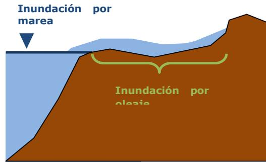
Figura nº33. Esquema de inundación por marea e inundación por oleaje.
