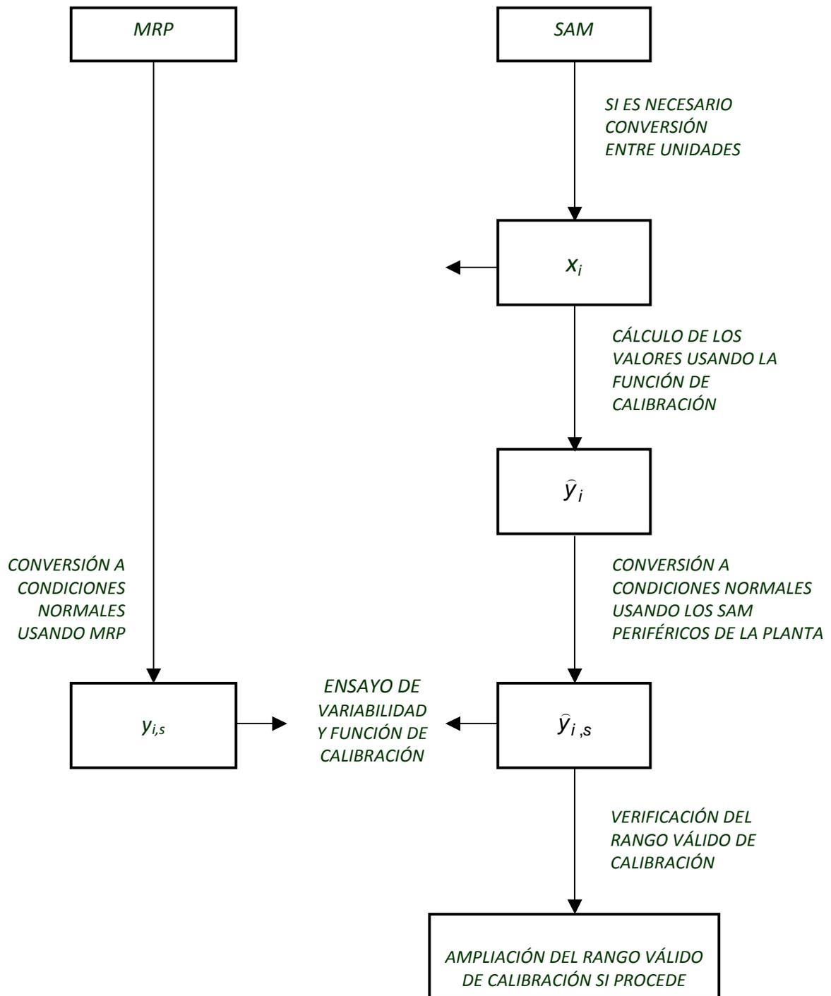
Se calculan los valores medidos del SAM  $\hat{y}_i$  (valores calibrados) a partir de las señales medidas del SAM  $x_i$  usando la función de calibración establecida (calculada de acuerdo al apartado 6.1.5) y se usa el equipo periférico del SAM para convertir  $\hat{y}_i$  a condiciones normales y calcular  $\hat{y}_{i,s}$
