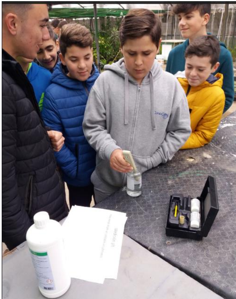
16. Medición de la conductividad eléctrica con el conductímetro.
