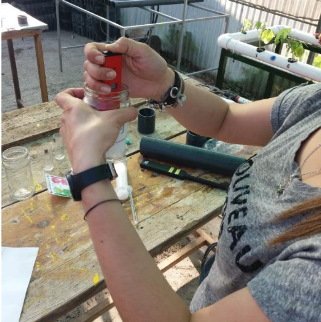
17. Medición de pH con pHmetro.
