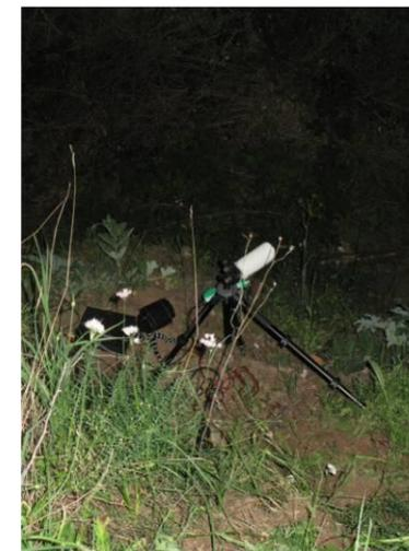
Cámara sensible a los infrarrojos con detector de ultrasonido que graba simultáneamente imagen y sonido.
