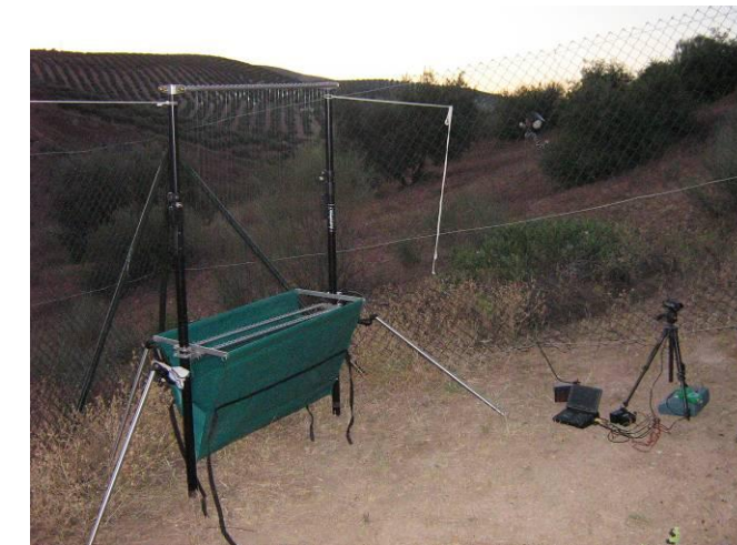
Cámara de vídeo sensible a los infrarrojos instalada en la entrada de la cueva del Yesos I, para realizar el censo de la colonia de cría cuando los murciélagos emergen de la cavidad. Una vez finalizada la grabación se realizan capturas con la trampa arpa.
