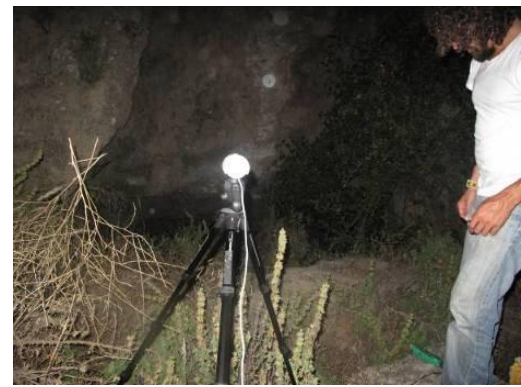
Instalación del equipo de grabación de cámara sensible a los infrarrojos con detector de ultrasonido para el censo de la colonia de cría (foto izda.). En la foto derecha dispositivo en funcionamiento.
