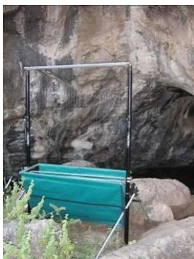
Trampa arpa instalada en la entrada del refugio al finalizar el censo (foto izda.). En la foto central y derecha individuo capturado para su identificación y posterior liberación.
