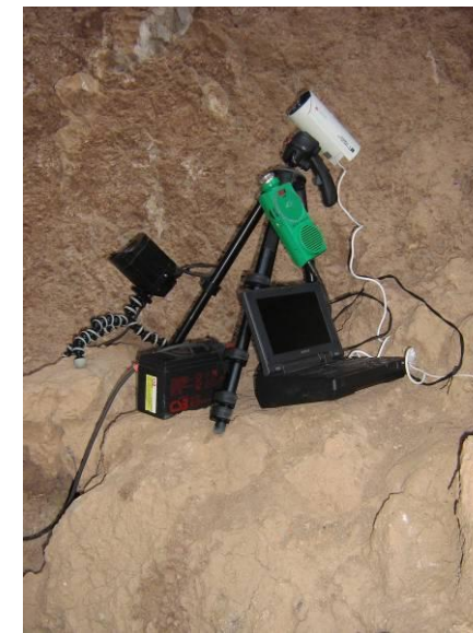
Cámara de vídeo sensible a los infrarrojos con detector de ultrasonidos instalada en la entrada de la cueva para el censo de la colonia de cría.
