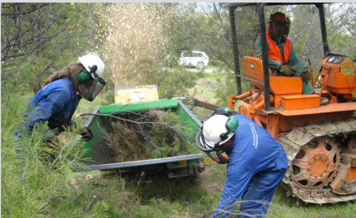
Tractor con astilladora astillando restos de vegetación, alimentada manualmente por dos operarios, en el T.M. Quesada (Jaén).
