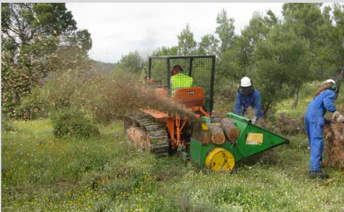
Tractor con astilladora astillando residuos, alimentada por dos peones en el T.M. Quesada (Jaén). (Obra 06_JA_227_5_2. Mejora de formaciones forestales en montes con problemas erosivos en la zona suroriental de Jaén).
