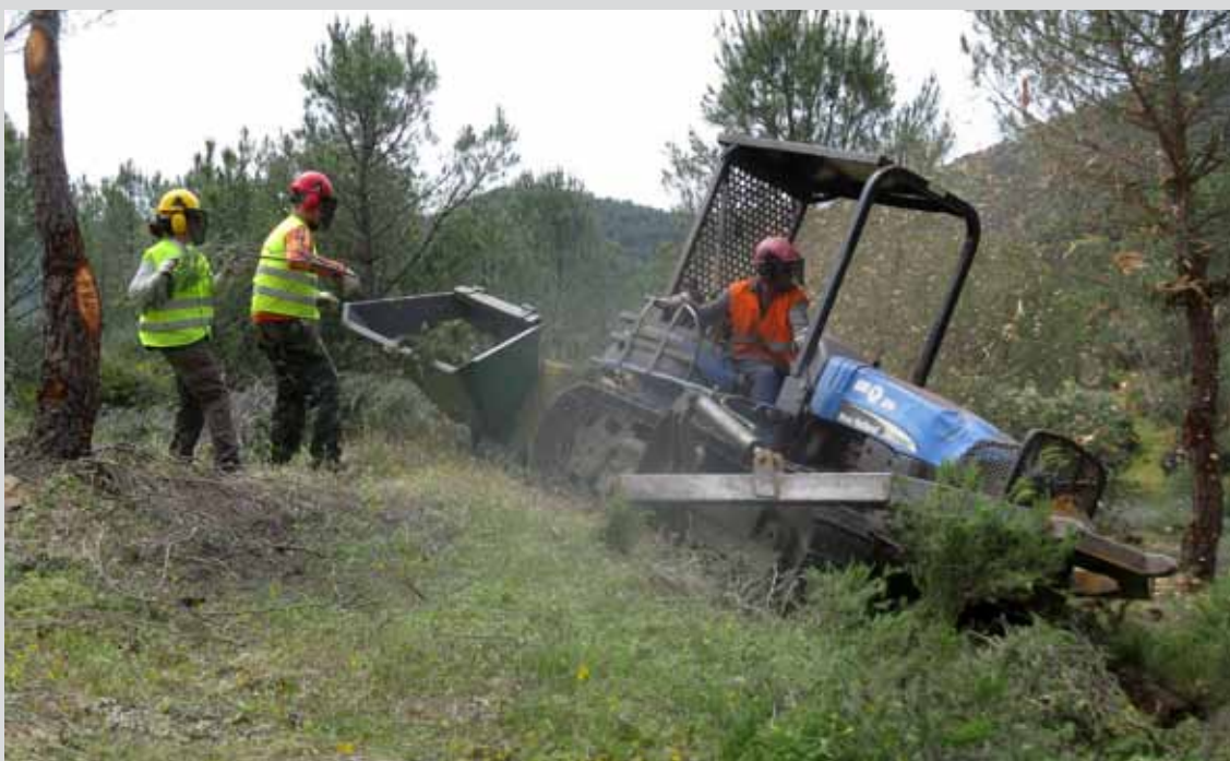
Astillado de residuos con astilladora propulsada por un tractor oruga, manejada por un maquinista y alimentada por dos peones, en el T.M. Chiclana de Segura (Jaén). (Obra 06_JA_226_123_4. Actuaciones selvícolas de mejora de la productividad de pino piñonero m/ "Las Beatas").
