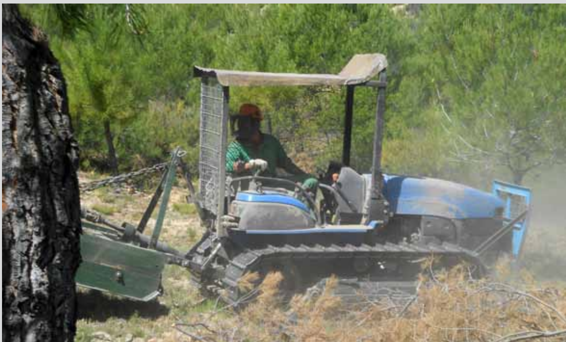
Desbroce de vegetación con desbrozadora acoplada a un tractor en el T.M. Jayena (Granada). (Obra 04_GR_226_4_1 TT.SS. de prevención de incendios forestales y de mejora de la capacidad productora de biomasa forestal, de uso energético y de pastos en el E.N. de Sierra Nevada y en el P.N. Sierras de Tejeda, Alhama y Almijara).
