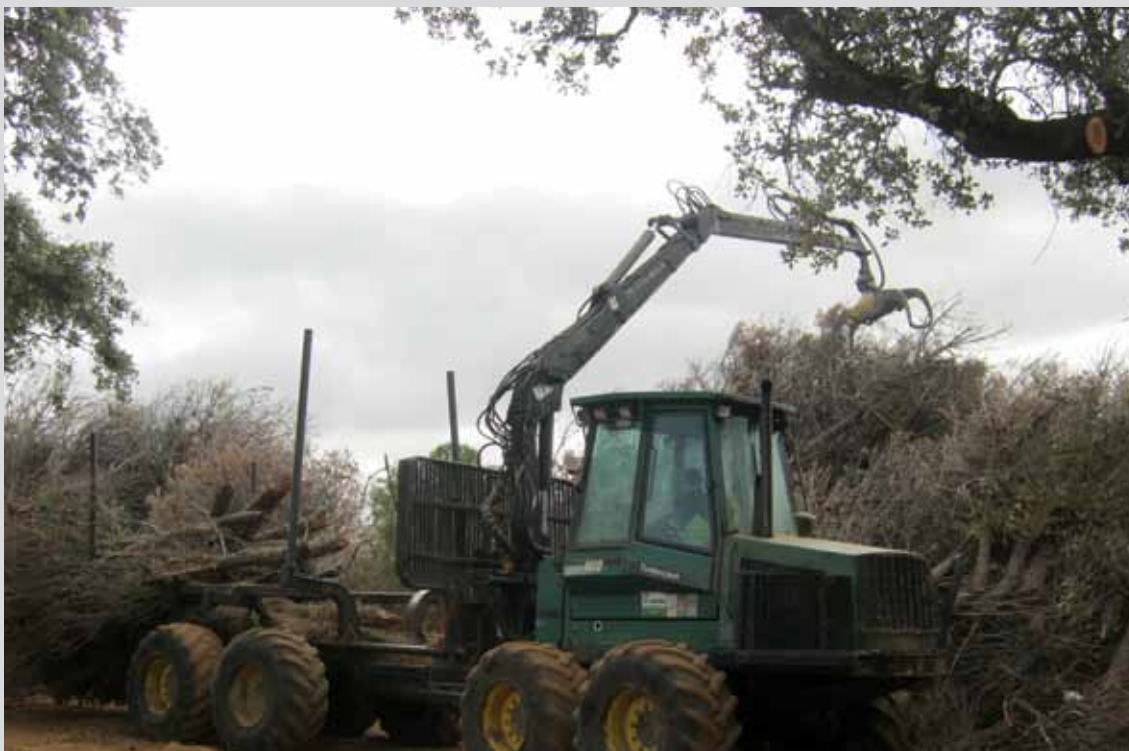
Autocargador sacando pinos en el T.M. El Castillo de las Guardas (Sevilla). (Obra 08_SE_226_123_2 Actuaciones selvícolas de prevención de incendios en los montes públicos de El Madroño, El Castillo de las Guardas, El Ronquillo y el Corredor Verde del Guadiamar).
