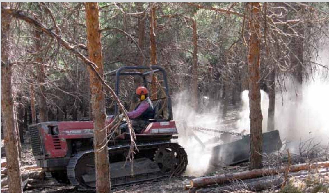
Eliminación de residuos con desbrozadora de cadenas en el T.M. Bacares (Almería). (Obra 01_AL_226_123_1 Tratamientos selvícolas preventivos y de mejora de los montes públicos de Sierra de Filabres).
