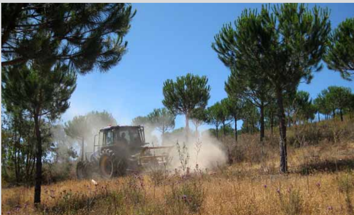
Eliminación de residuos con desbrozadora de martillo en el T.M. El Granado (Huelva). (Obra 05_HU_226_123_2 Actuaciones selvícolas y de prevención de incendios en montes de la provincia de Huelva).
