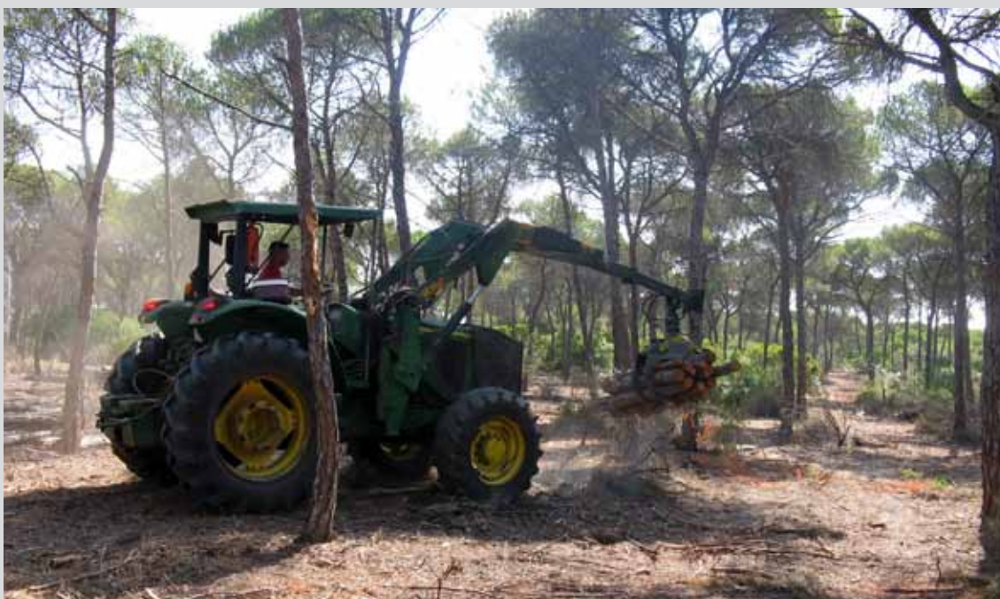
Saca de madera con tractor implementado con pinzas en el T.M. Cartaya (Huelva). (Obra 05_HU_226_5_2 Proyecto de actuaciones selvícolas y de prevención de incendios en los términos municipales de Moguer y Cartaya).
