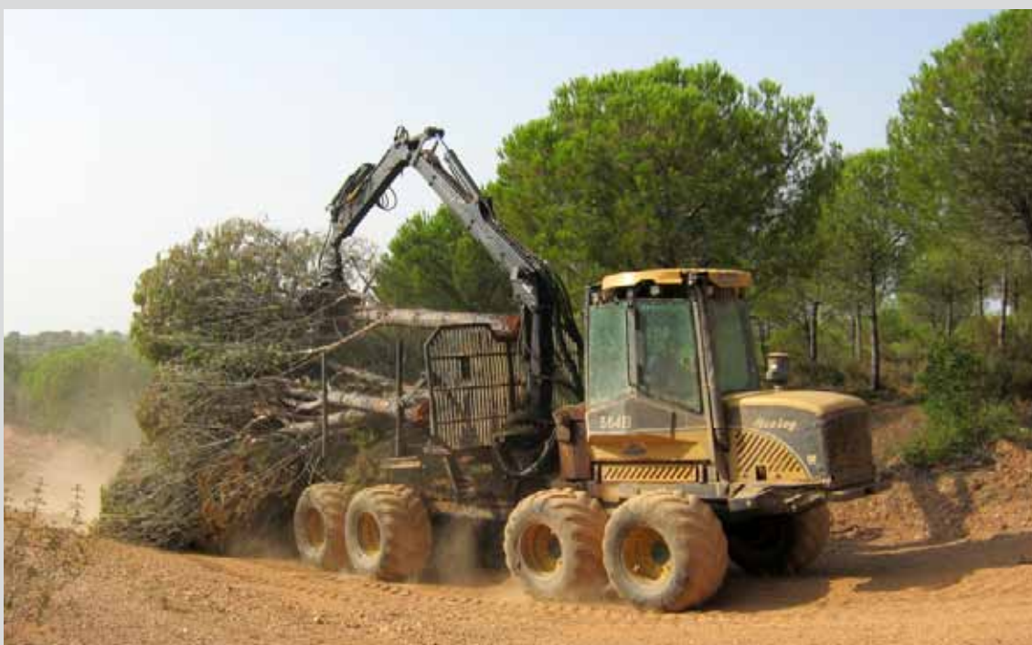
Autocargador sacando pinos apeados a la zona de astillado en el T.M. Aznalcóllar (Sevilla). (Obra 08_SE_226_4_1 Actuaciones selvícolas de prevención de incendios y de mejora productora en los montes públicos de Madroñalejo y Dehesa del Perro del T.M. de Aznalcollar (Sevilla)).
