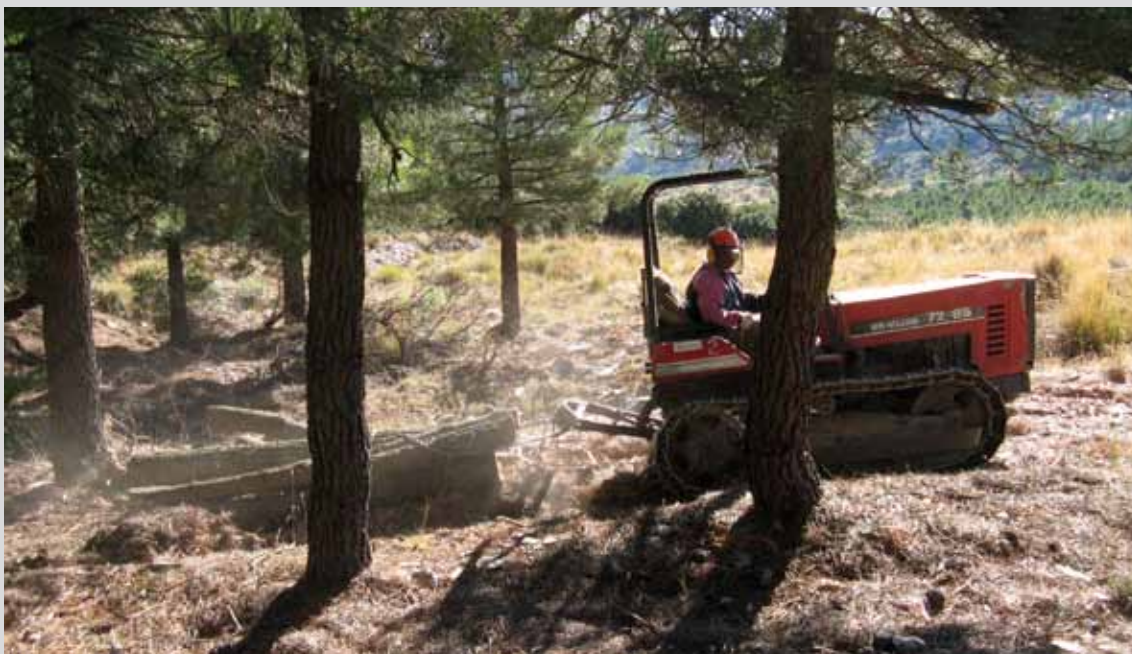
Tractor oruga realizando desembosque de madera en el T.M. Laroya (Almería). (Obra 01_AL_226_123_1 Tratamientos selvícolas preventivos y de mejora de los montes públicos de Sierra de Filabres).
