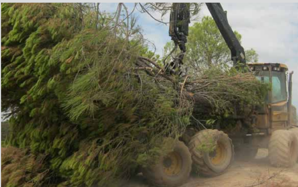
Autocargador sacando pinos apeados en el T.M. Aznalcóllar (Sevilla). (Obra 08_SE_226_4_1 Actuaciones selvícolas de prevención de incendios y de mejora productora en los montes públicos de Madroñalejo y Dehesa del Perro del T.M. de Aznalcóllar. Sevilla).
