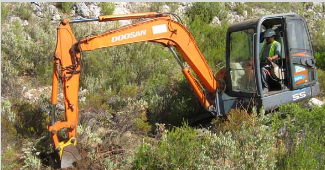
Retroaraña realizando ahoyado mecanizado en el T.M. Segura de la Sierra (Jaén). (Obra 06_JA_226_4_2 Actuaciones silvícolas de prevención de incendios, de mejora productora, de corrección hidrológica y restauración en el P.N. Cazorla, Segura y Las Villas (Sierra de Segura)).
