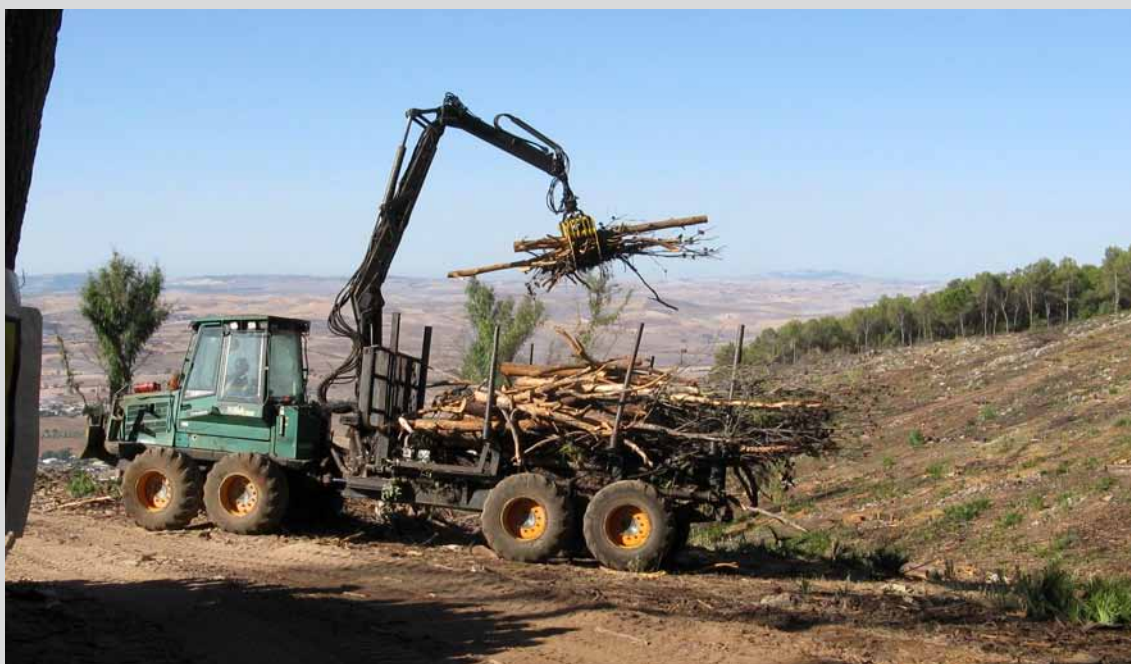
Saca de madera con autocargador en el T.M. Montellano (Sevilla). (Obra 08_SE_226_5_2 Actuaciones selvícolas de prevención de incendios y restauración en los montes de Montellano).
