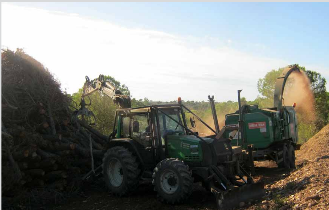
Astillado de arbolado en el T.M. Aznalcóllar (Sevilla). (Obra 08_SE_226_4_1 Actuaciones selvícolas de prevención de incendios y de mejora productora en los montes públicos de Madroñalejo y Dehesa del Perro del T.M. de Aznalcóllar. Sevilla).
