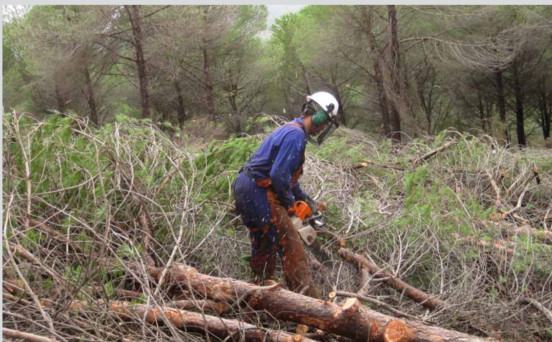
Motoserrista realizando apeo, desramado y tronzado de pinos en el T.M. Cortegana (Huelva). (Obra 05_HU_227_5_1 Proyecto de restauración de hábitats en Sierra Pelada. Provincia de Huelva).
