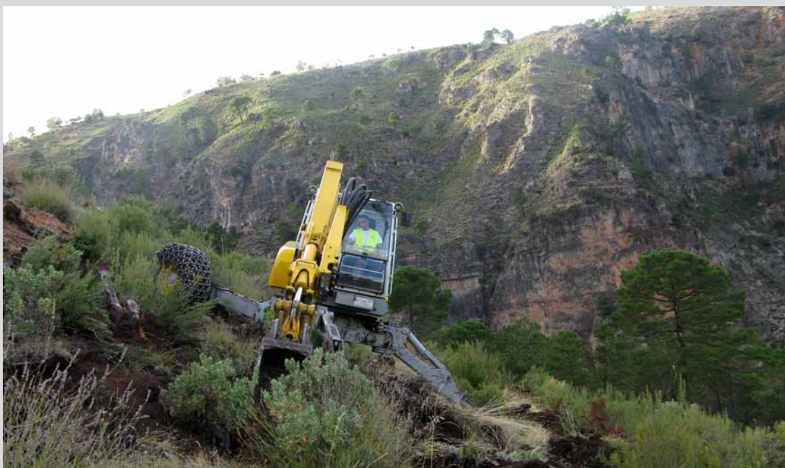
Retroaraña realizando ahoyado en el T.M. Villanueva del Arzobispo. (Obra 06_JA_226_4_1 Actuaciones selvícolas de prevención de incendios, de mejora productora, de corrección hidrológica y restauración en el "P.N. Cazorla, Segura y Las Villas" (Sierras de Cazorla y las Villas).
