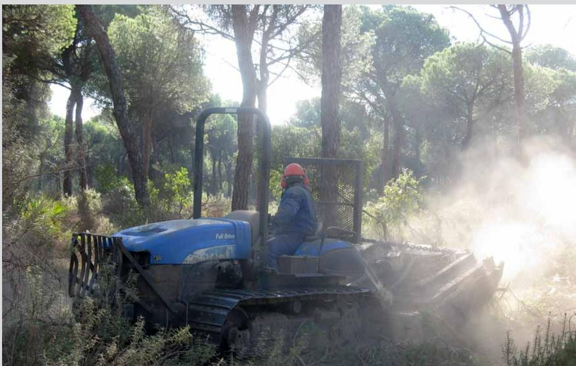
*Tractor oruga desbrozando con desbrozadora de cadenas en el T.M. Moguer (Huelva).
