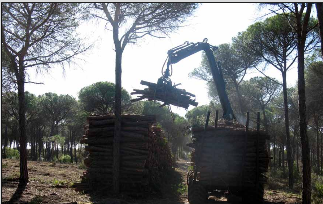
Autocargador forestal realizando trabajos de saca de madera en el T.M. Cartaya (Huelva). (Obra 05_HU_226_5_2 Proyecto de actuaciones selvícolas y de prevención de incendios en los términos municipales de Moguer y Cartaya).
