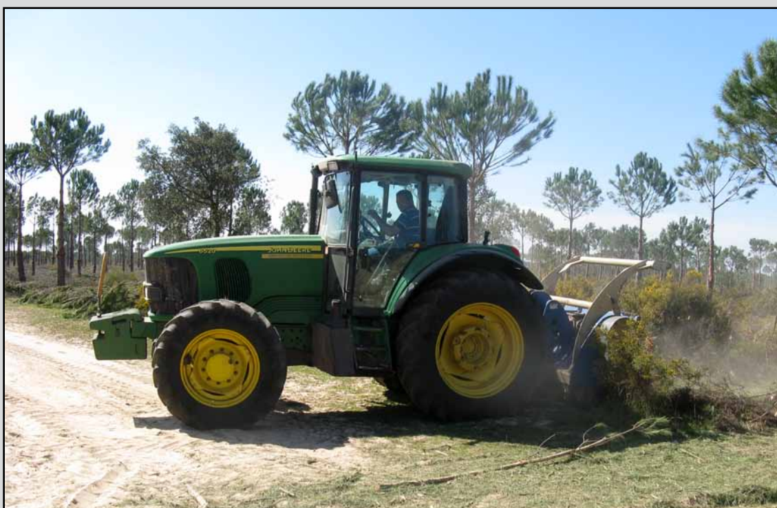
Desbroce mecanizado con tractor agrícola en el T.M. Moguer (Huelva). (Obra 05_HU_226_5_3 Proyecto de actuaciones selvícolas y de prevención de incendios en el P.N. de Doñana).
