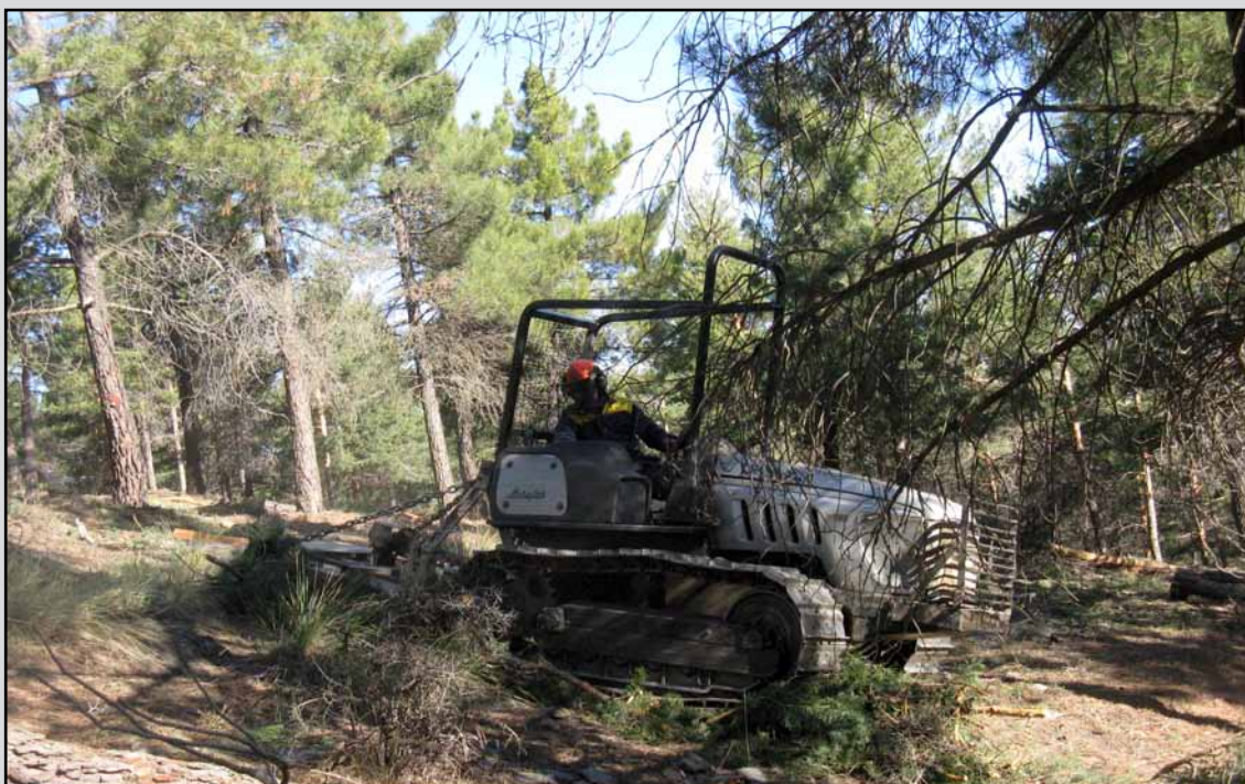
Eliminación de residuos con desbrozadora de cadenas en el T.M. Bacares (Almería). (Obra 01_AL_226_123_1 Tratamientos selvícolas preventivos y de mejora de los montes públicos de Sierra de Filabres).
