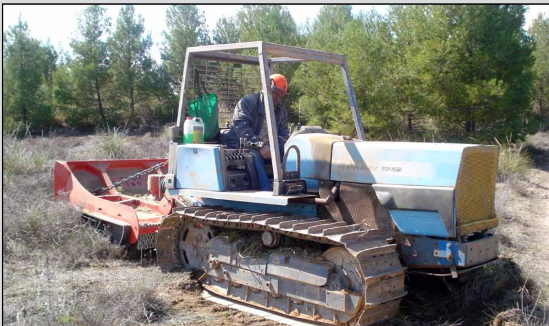
Eliminación de residuos con desbrozadora de cadenas en el T.M. Fonelas (Granada). (Obra 04_GR_226_4_2 TT.SS. de prevención de incendios forestales y de mejora de la capacidad productora de biomasa forestal de uso energético y de pastos en varios montes públicos de la provincia de Granada).
