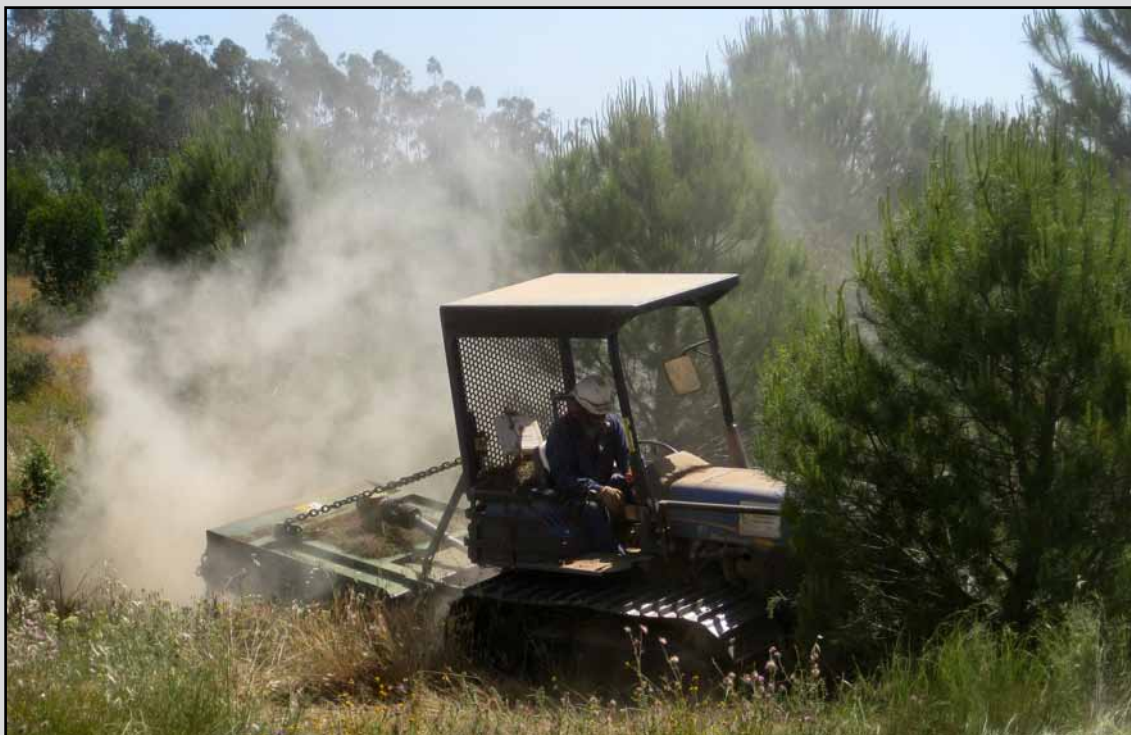
Desbroce con desbrozadora de cadenas en el T.M. Trigueros (Huelva). (Obra 05_HU_226_5_4 Proyecto de actuaciones selvícolas y de prevención de incendios en varios términos municipales de Huelva).
