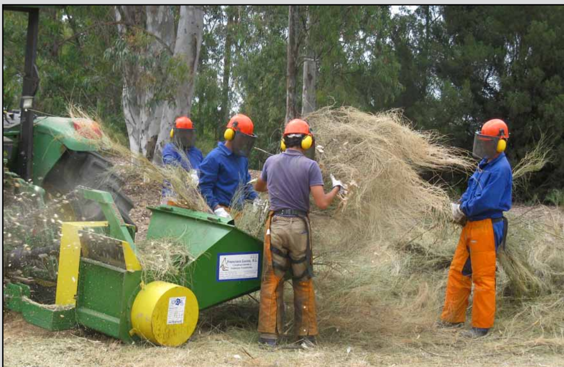
Astillado de residuos en el T.M. Palos de la Frontera (Huelva). (Obra 05_HU_226_4_2 Proyecto de actuaciones selvícolas y puesta en producción de pinares de Huelva).
