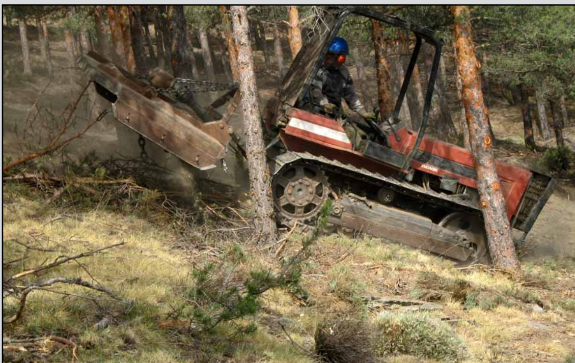
Eliminación de residuos con desbrozadora de cadenas en el T.M. Bacares (Almería). (Obra 01_AL_226_F2_3 Mejora del potencial biológico y forestal en el monte público El Conde. Provincia de Almería).
