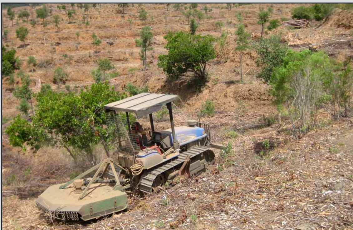
Desbroce con desbrozadora de cadenas en el T.M. Almonaster la Real (Huelva). (Obra 05_HU_226_123_2 Actuaciones selvícolas y de prevención de incendios en montes de la provincia de Huelva).
