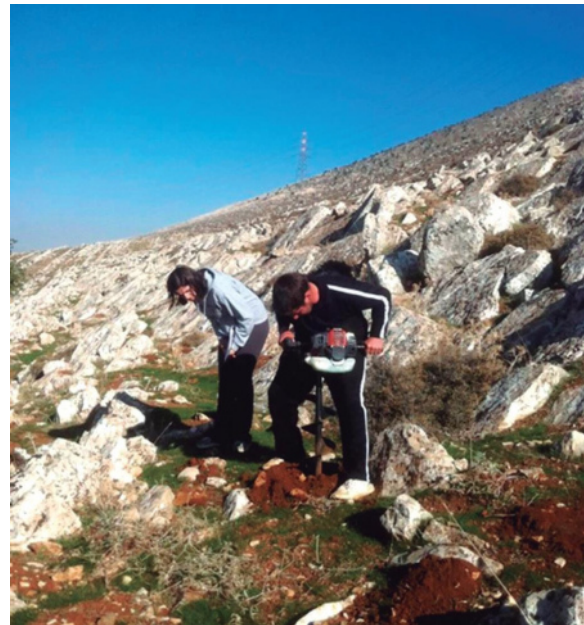
Foto 46. Ahoyadora helicoidal de uso unipersonal que puede ser de gran utilidad para siembra de bellotas.
