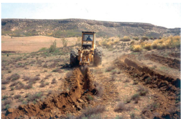
Foto 43. Preparación del suelo lineal siguiendo líneas de nivel en el área experimental de Cortijo de Becerra (Guadix, Granada).
