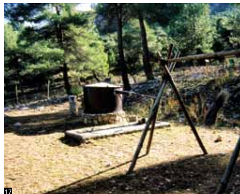
Caldera de destilación de esencias aromáticas
