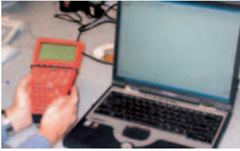
Desde 1994 se utiliza un sistema de medición de superficies con tecnología GPS que permite conocer la extensión de las áreas quemadas, cuando el incendio está activo o una vez extinguido.
