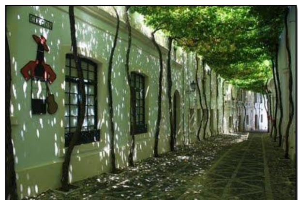
Ilustración 17. Las calles emparradas son una buena técnica de climatización para calles estrechas, ya que apenas obstaculizan una vía pública ya de por sí estrecha, son fáciles de tuturar, no apantallan ventanas y pierden las hojas en los meses fríos.
