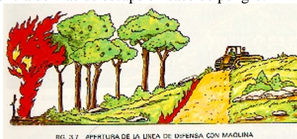
FIG. 3.7 APERTURA DE LA LINEA DE DEFENSA CON MAOLINA
