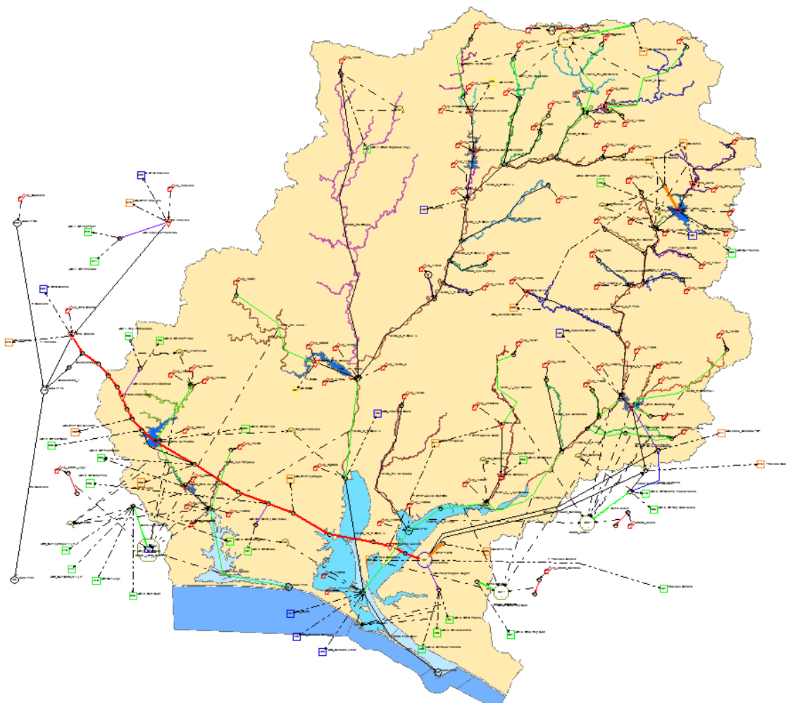
Figura 5.1.3. (1): Topología del modelo de simulación del sistema de explotación Huelva para el escenario actual
