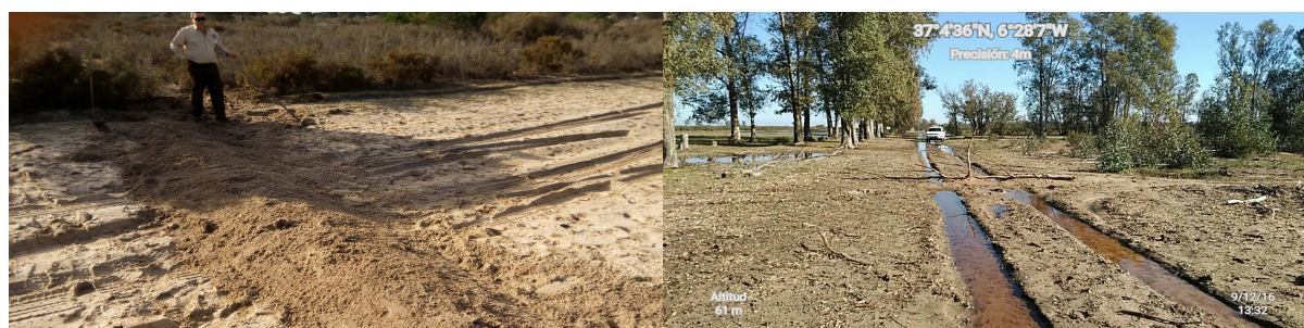
A.M.A. Realizando uno de los frenos erosivos del ensayo.
