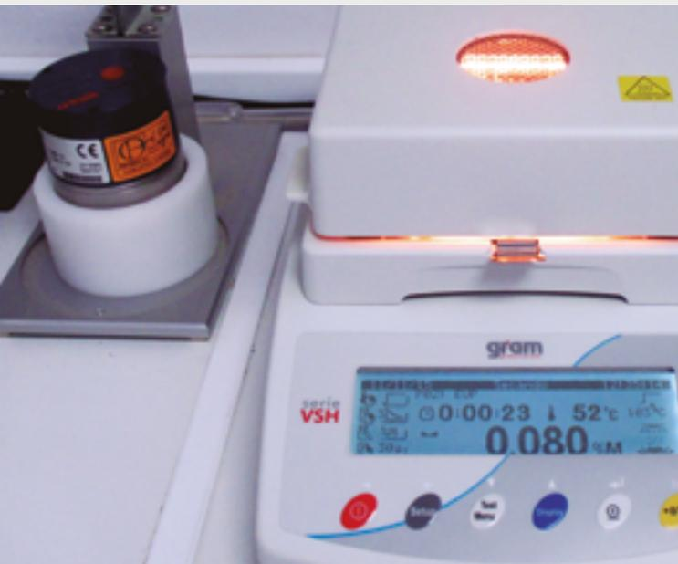
Ensayos de determinación de humedad
