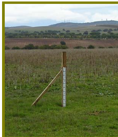
En la cubeta se ha instalado una escala para el registro del nivel del agua.
