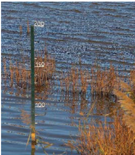
Niveleta para medida del nivel del agua
