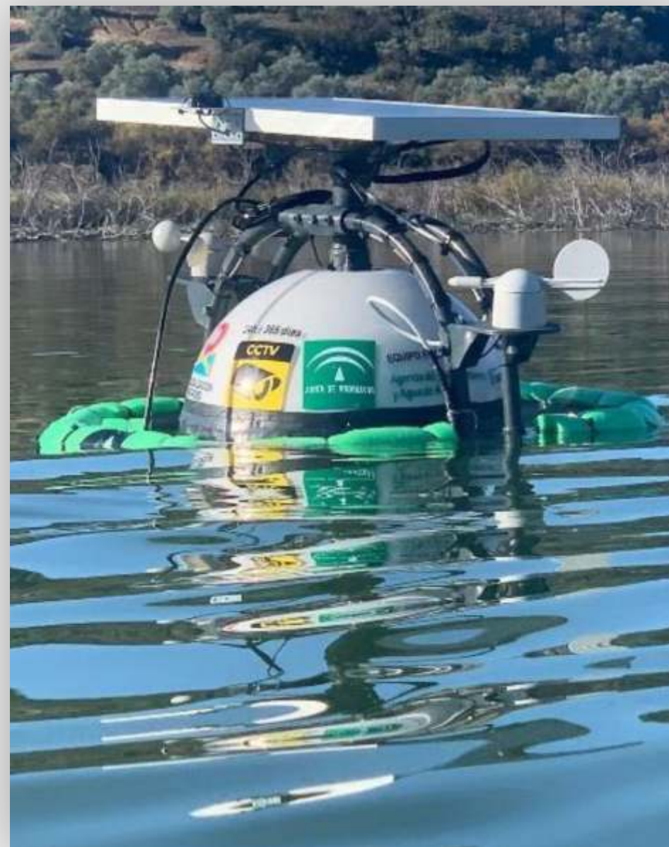
Detalle de sonda multiparamétrica (© Junta de Andalucía)
