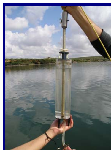
Muestra de agua extraída a 13 m de profundidad, en la que se puede observar la transparencia del agua.
