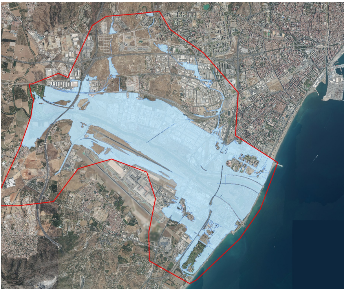
Figura 1. Situación preoperacional: extensión de la zona inundable para periodo de retorno T-500 años
