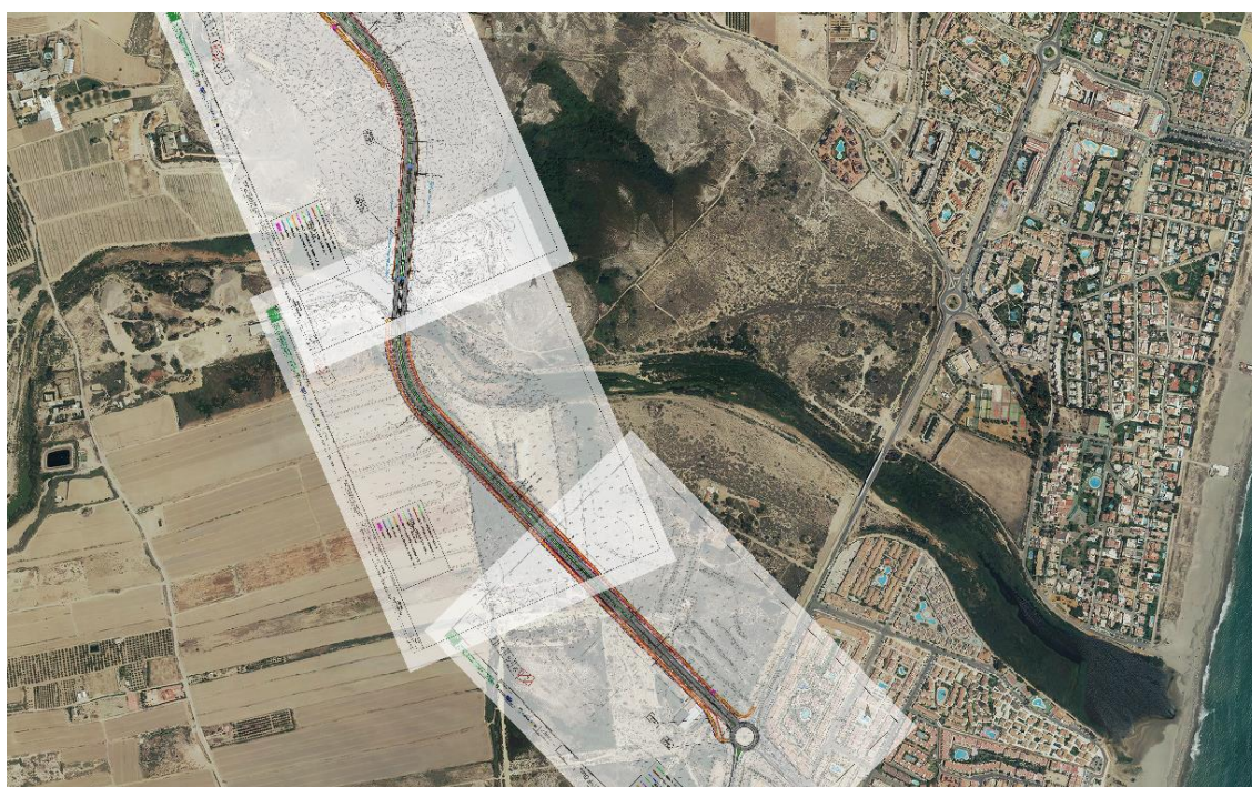
Figura 4: Desdoblamiento de la carretera A-352.
