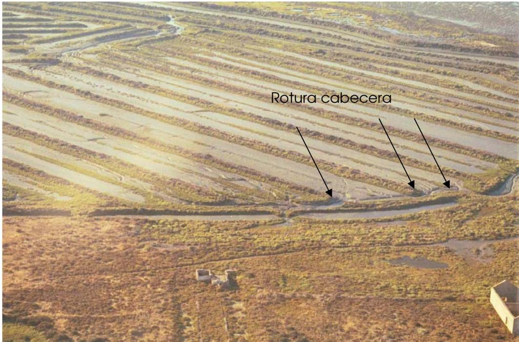
**Figura 28:** En el centro inferior se observa la cabecera de los cristalizadores de la zona de actuación con proliferación de fango y rotura de muro. En la zona central derecha se observa la falta de comunicación con el canal de alimentación.
