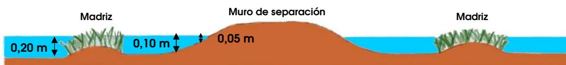
**Figura 89:** Vista general de los muros de los cristalizadores una vez efectuadas las obras de manejo.
