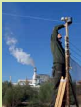
Colocación de captador difusivo en campo
