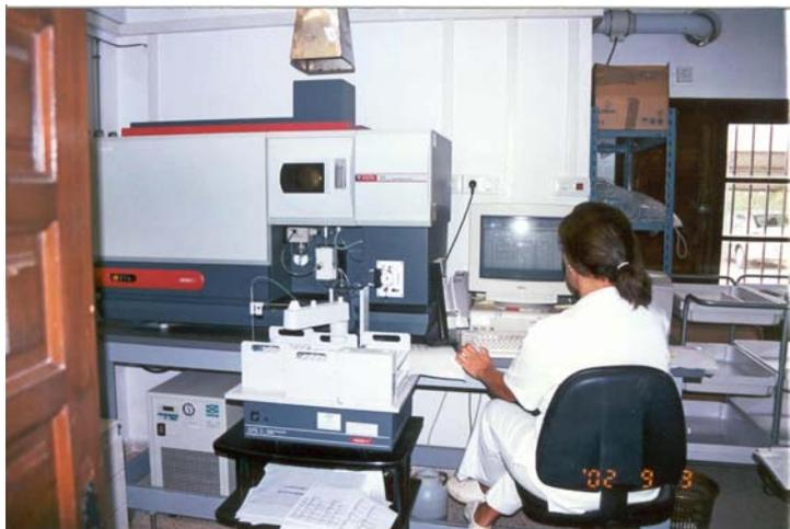
Los compuestos metálicos presentes en las muestras se reducen a estado elemental una vez aspirados en la llama de un mechero. Los átomos, en fase gaseosa, absorben radiaciones cuyas energías coinciden exactamente con las de sus transiciones electrónicas. Las líneas de absorción atómica son muy estrechas y las energías de transición son características
