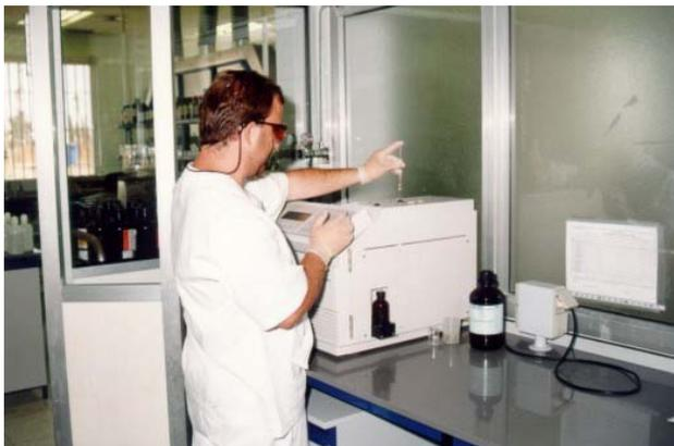
La muestra es pasada a través del sistema de flujo en el que se ha colocado una columna de reducción de cadmio con lo cual el nitrato presente en la muestra se reduce a nitrito. El nitrito, el presente originalmente en la muestra más el nitrito producido a partir del nitrato reducido, en medio ácido, provoca la reacción de diazotación con la sulfanilamida para
