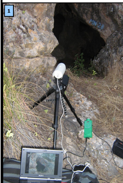
Cámara fija sensible a los infrarrojos y detectores de ultrasonidos, conectados a un videoreproductor de Alta Definición. La videogradora permite grabar de forma simultánea la imagen, a través de la cámara, y el sonido, con el detector de alta frecuencia a modo de micrófono, de los murciélagos cuando emergen de la cavidad.
