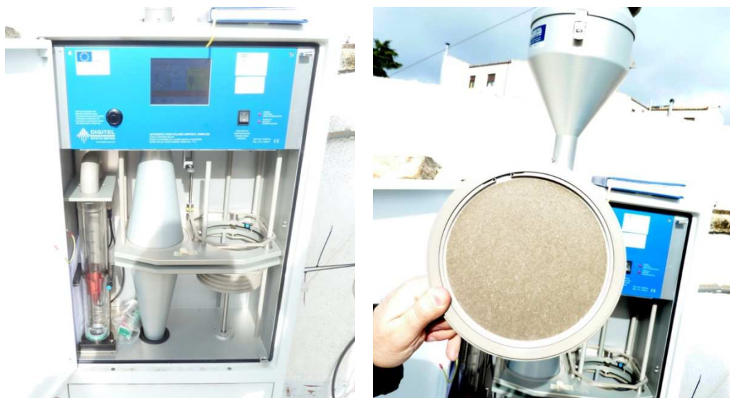
Figura 5.1. Captador secuencial Digitel (izquierda) con cabezal de punto de corte específico para PM_{10} y portafiltras (derecha) utilizado en el muestreo de Villanueva del Arzobispo
