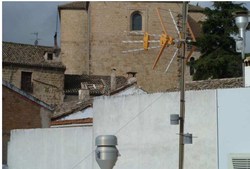
Figura 3.2. Cabezales de aspiración de aire ambiente de los equipos de medida de partículas (gravimétrico y automático) de la estación de Villanueva del Arzobispo y localización de chimeneas de instalaciones residenciales que utilizan biomasa, principalmente leña o restos de poda.
