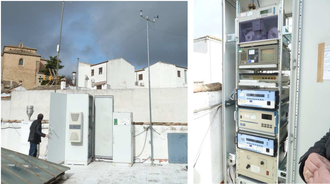
Figura 3.1. Equipos de medida de la estación de Villanueva del Arzobispo en su ubicación anterior a marzo de 2014.
