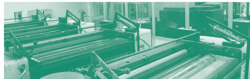
Detalle de la tinta en los rodillos de una impresora offset.
