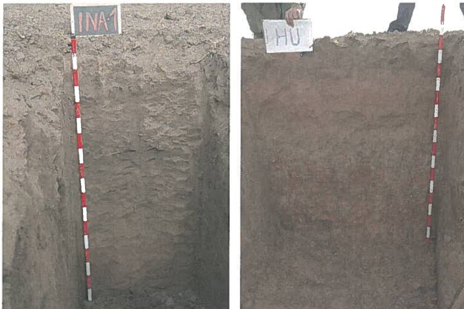
Figura 4. Estudio diagnóstico del perfil del suelo mediante calicatas. Izquierda, perfil bastante homogéneo. Derecha, perfil con horizontes marcadamente diferentes
