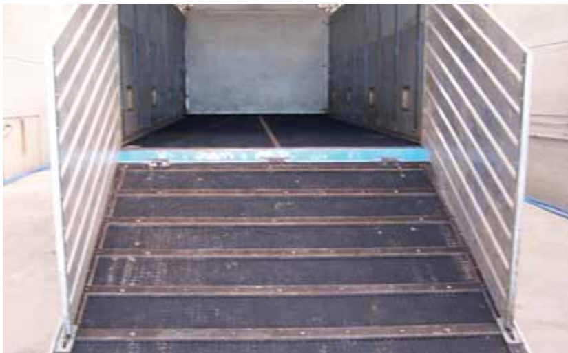
Figura 6. Rampa de embarque con barreras laterales y listones transversales
