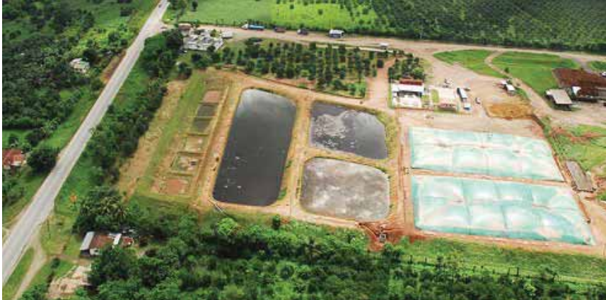
Figura 8. Sistemas de depuración biológica por oxidación
