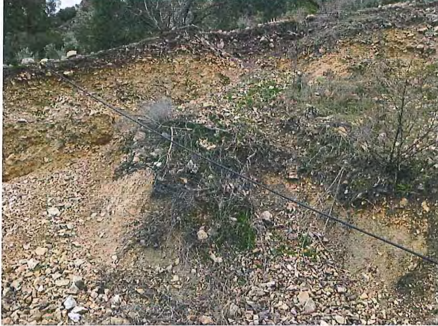
Vista del escarpe del movimiento desarrollado en su totalidad en derrubios de pie de monte.
