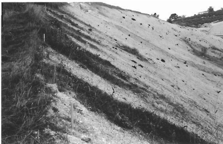
Foto 10. Talud revegetado en su parte superior. Se observan las franjas abonadas con abundante vegetación, y las no abonadas con escasísima emergencia y cobertura. Foto S. Sánchez.
